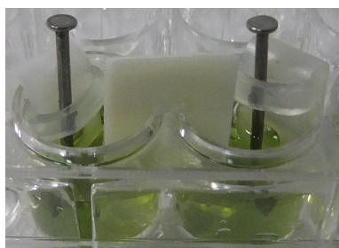
実験開始前のセル、電極にステンレス釘、塩橋はろ紙
