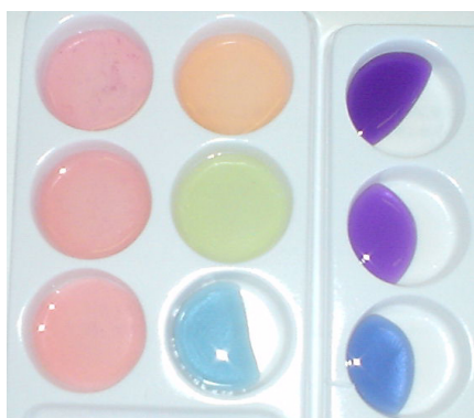
Fig. 2: 広域指示薬の呈色：左の列 上から順に pH 0, 1, 3 中央の列 上から順に pH 5,7,9 右側の列 上から順に pH 11,13,14
