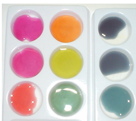
Fig. 1: 山田式万能指示薬の呈色：左の列 上から順に pH 0, 1, 3 中央の列 上から順に pH 5,7,9 右側の列 上から順に pH 11,13,14
